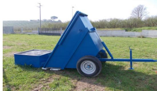
Questo modello di vasca è dotata di timone, pistone idraulico per il ribaltamento e ruote. Qui i residui e i sassi per via del loro peso specifico si depositano sul fondo. Una volta eseguiti i cicli di lavaggio necessita di essere svuotata quando piena.
