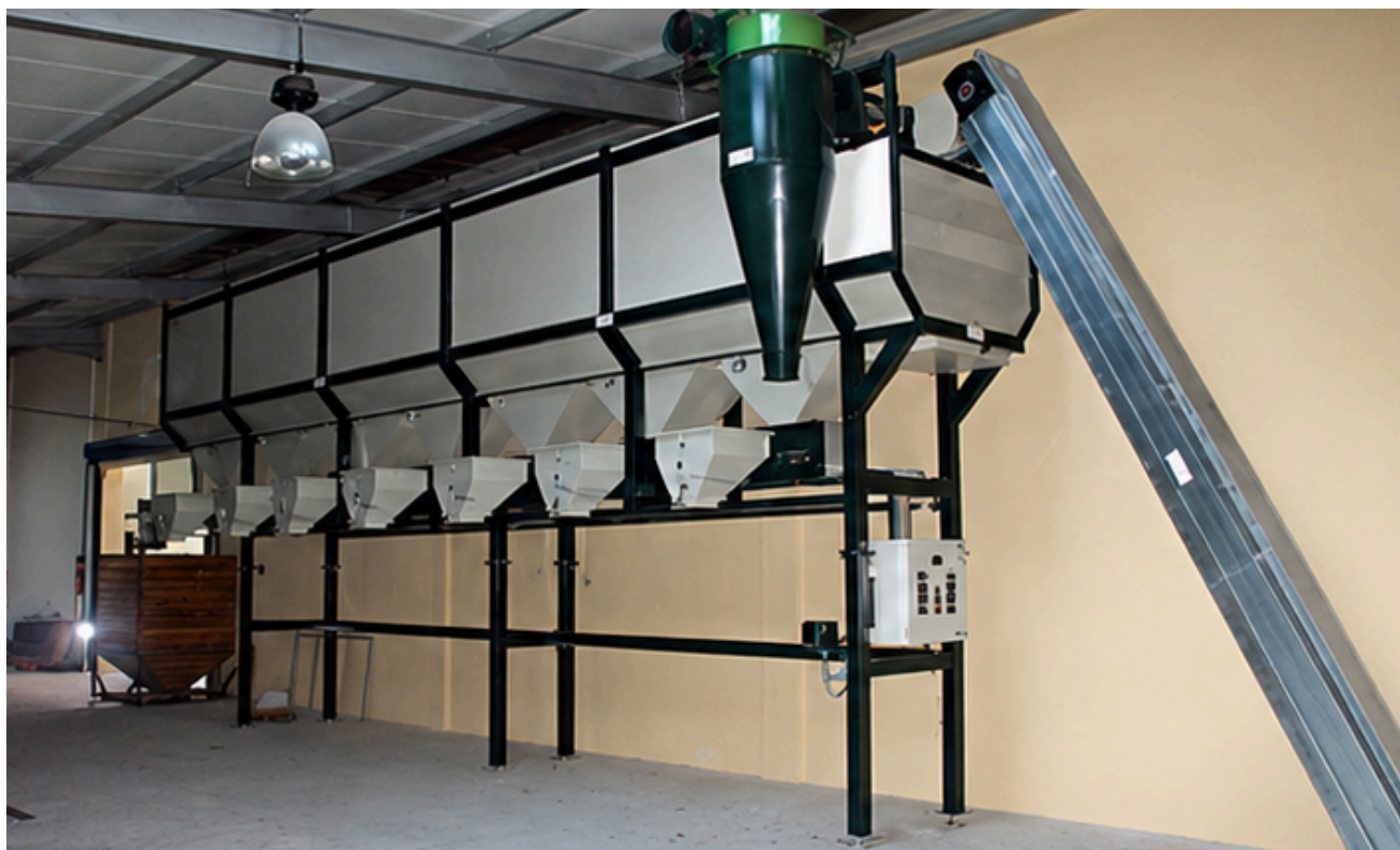
Alcuni modelli di vaglio calibro selezionatore per la divisione delle castagne per dimensione.
