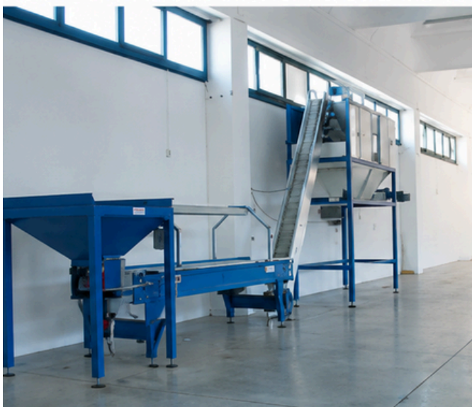
Foto 1: linea di cernita e lucidatura castagne. Foto 2 e 3: linee di cernita manuale delle castagne con operatore.
