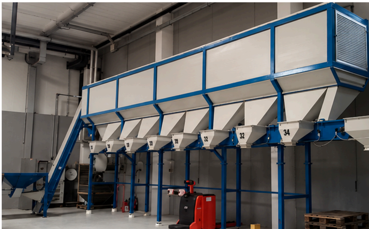
Alcuni modelli di vaglio calibro selezionatore per la divisione delle castagne per dimensione.
